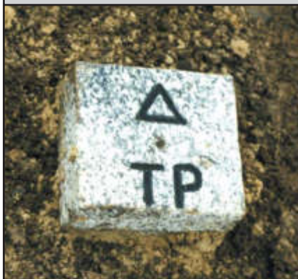
BFP/TP Granitpfeiler 16 cm x 16 cm (auch bodengleich)*
